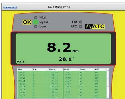
Connecté à un PC, visualisation du dernier vissage et stockage des résultats pour analyse.
