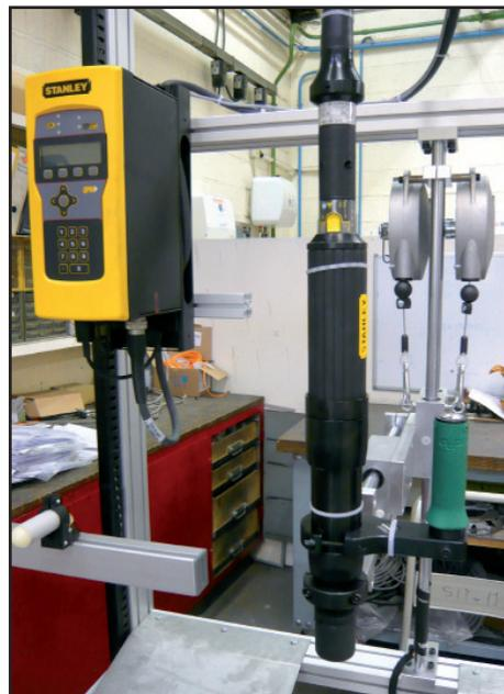
3. Poste de travail avec visseuse axiale **160 Nm** sur bras de réaction.
