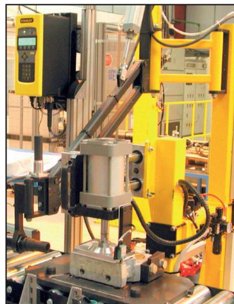
6. Visseuse horizontale **600 Nm** montée sur bras pantographe avec système de bridage de pièce.
