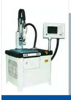
Il s'agit du procédé le plus innovant pour le **soudage d'écrous** par arc rotatif magnétique. Cette machine est spécialement conçue pour souder rapidement et proprement des écrous de diamètre extérieur 6 à 30 mm, hauteur 4 à 30 mm. Ce procédé peut être utilisé pour toutes les applications, il est en particulier apprécié pour les lignes d'échappement automobile : écrous de fixation des sondes.
