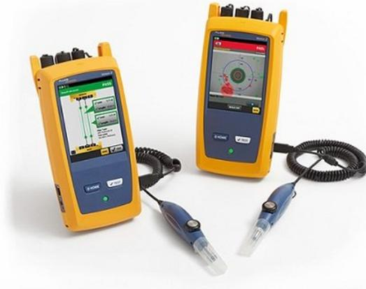
La capacité de certification des fibres optiques aux deux extrémités de CertiFiber Pro vous permet d'inspecter et de certifier le connecteur de la fibre optique aux deux extrémités de votre liaison fibre optique en moins d'une seconde afin d'accomplir vos tâches correctement dès la première tentative. La certification automatisée de conformité/non-conformité écarte toute conjecture lors de l'inspection des fibres, de sorte que n'importe qui peut être un expert en fibre optique.
