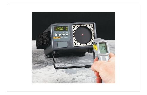
**9132** Étalonneur IR portable, 500 °C
